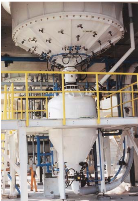
Transportador en fase densa y descarga fluidificada de silo Vibra-Jet™ para detergentes
