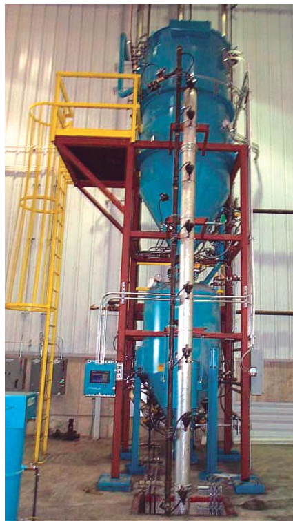
Sistema de transporte HDV™ de alta densidad en vacío Concepto Línea Llena™ en descarga de camiones
