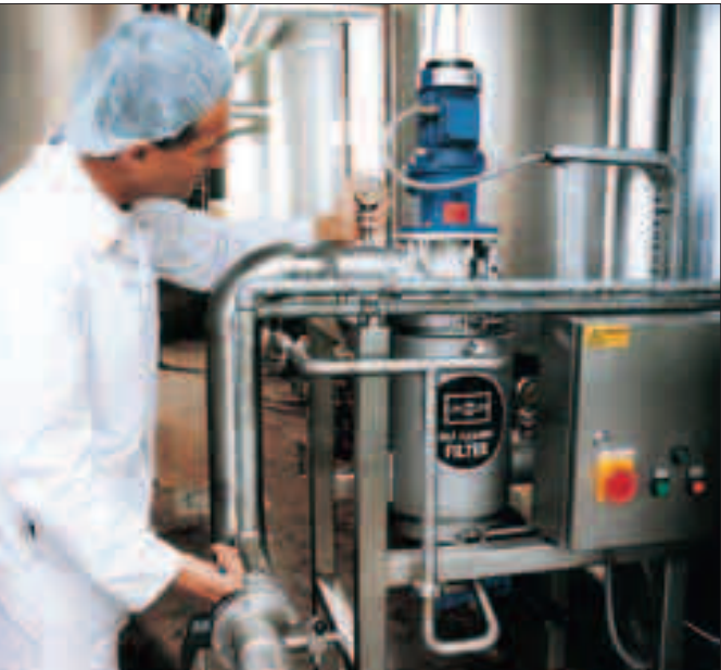
Los Filtros Autolimpiantes Russell Eco Filters® ayudan a los procedimientos de control de calidad para filtrar chocolate líquido en Walls Ice Cream.
